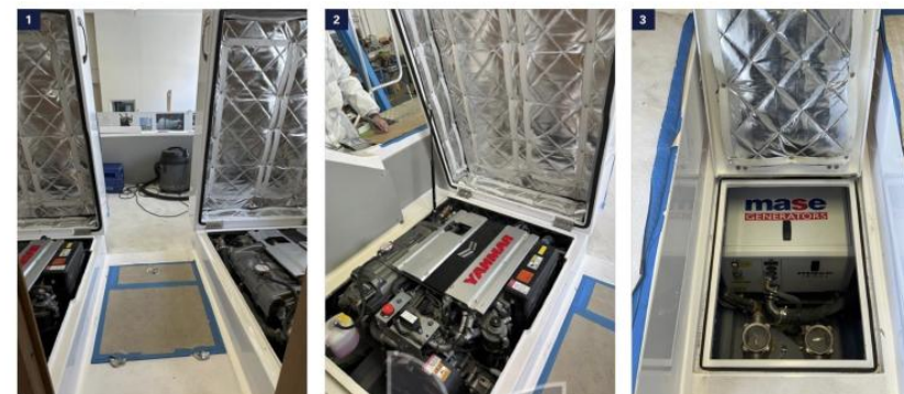
Nei due cassoni aperti è ben visibile il buon accesso ai motori sia frontalmente che lateralmente dal portello centrale (foto 1).
