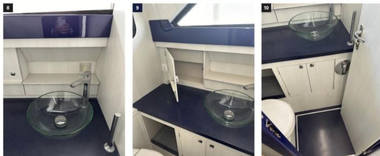
Tutti gli spazi sono stati sfruttati a ripostiglio chiuso o a vista. Tutti gli sportelli sono muniti di push pull lock (foto 9).
