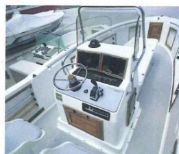
La vista della consolle centrale evidenzia la cura riposta nella protezione della strumentazione coperta da sportelli di plexiglass.
